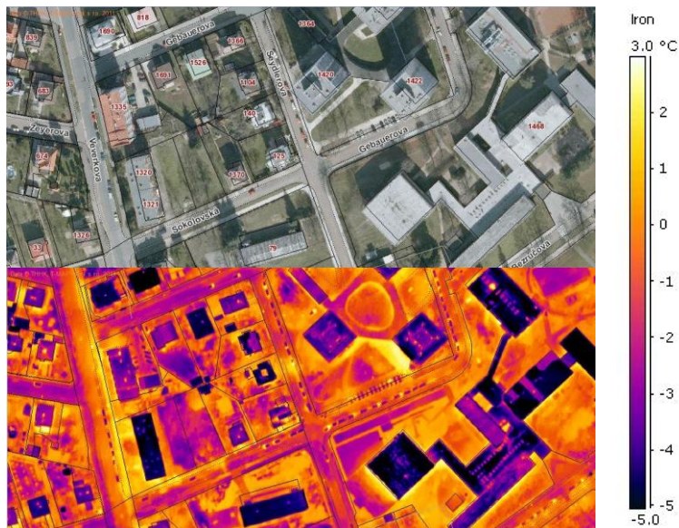
Rys. Przykład termogramu przedstawiającego rozkład temperatury dla fragmentu obszaru miejskiego.
